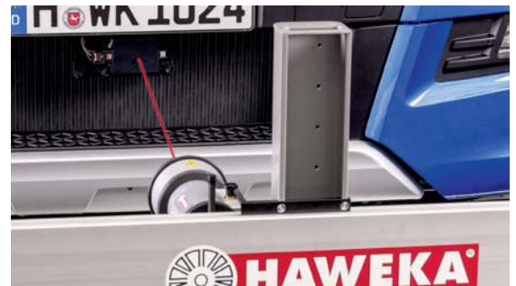
Настройка камеры SAD4000 на ACC-датчик
