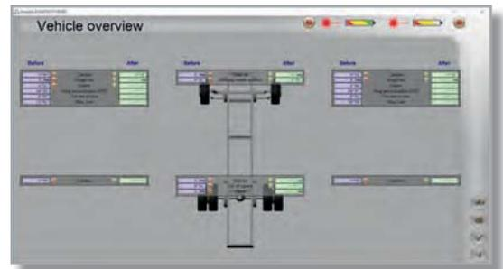
После измерения развала, например, можно отрегулировать его в режиме реального времени.
