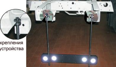
Детальное изображение элемента крепления для измерительного устройства
